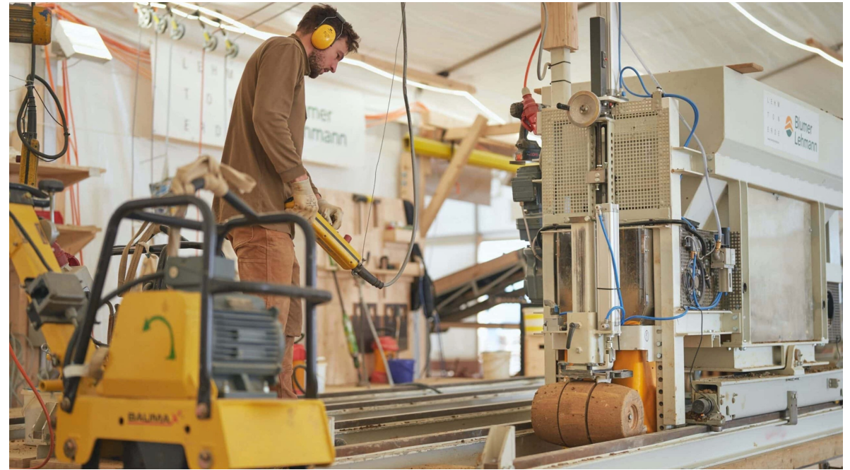
Doppelt-konische Walze auf Schienen um Wölbung zu erhalten
