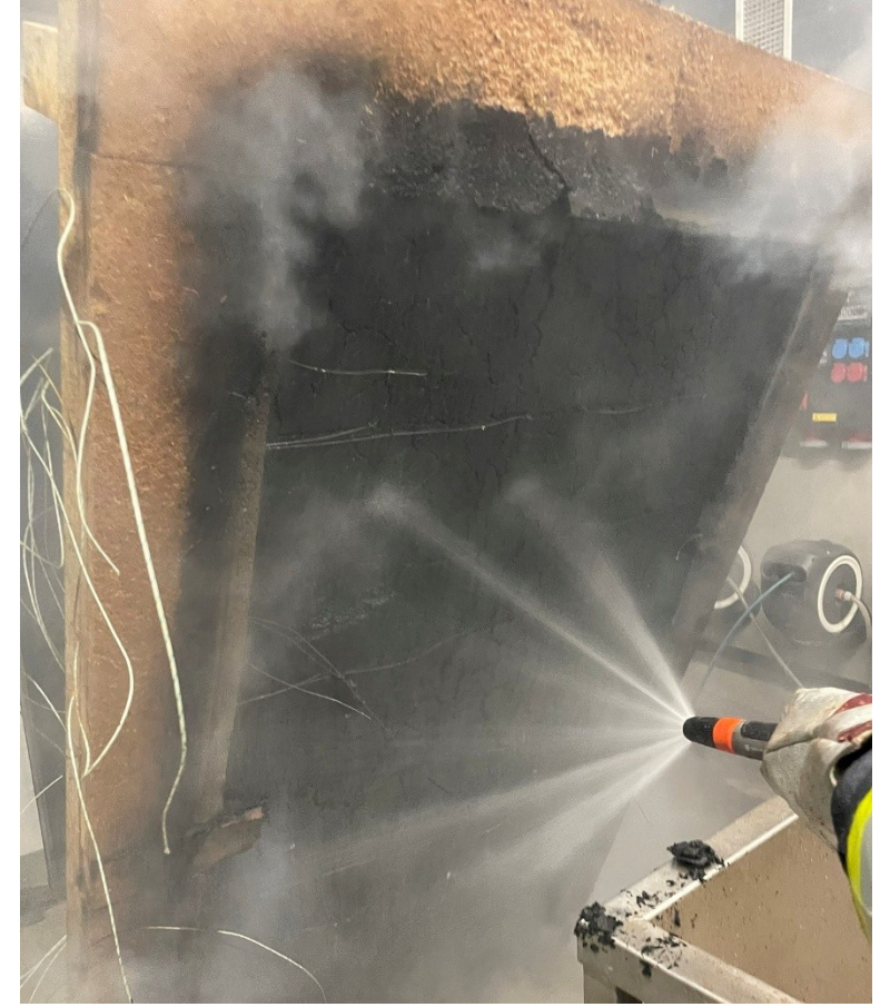
Feuer an der Spanplatte löschen
