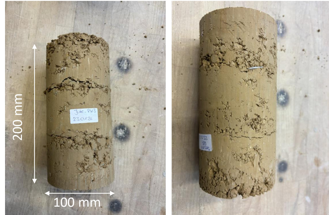
Deutliche Rissbildung bei Jute-/Kokosgewebe
