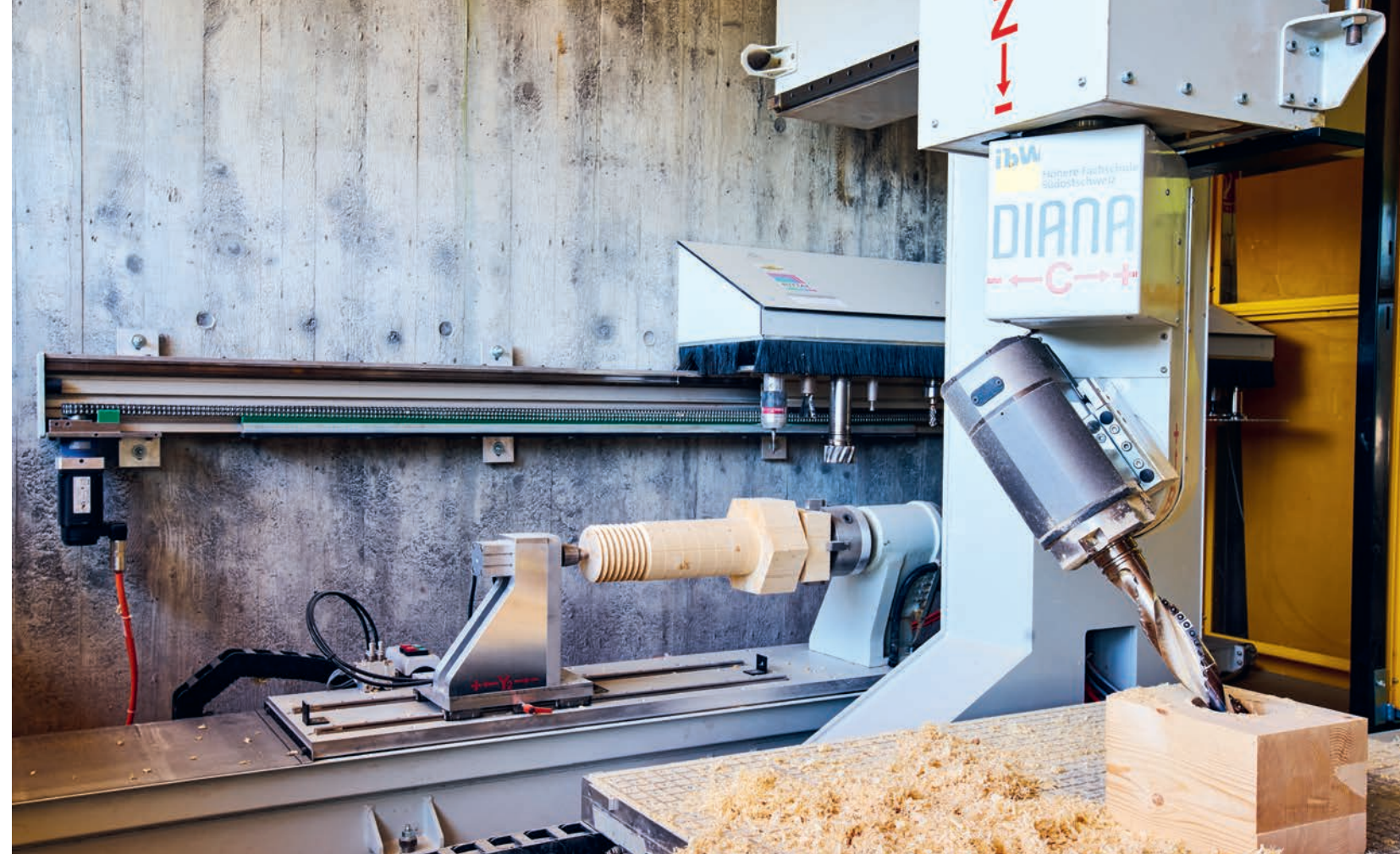
An der ibW entwickelte CNC-Fräsmaschine: die ibW «Diana».
